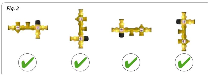
Il kit può anche essere configurato a seconda delle necessità impiantistiche ruotando la valvola deviatrice o il giunto rispetto alla valvola miscelatrice per cambiare le direzioni delle tubazioni (fig 3).
